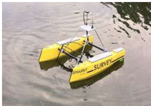
Rys. 4. Dron pływający USV „Sharky” podczas przygotowań do testów (po lewej) oraz w trakcie kampanii walidacyjnej (po prawej)
