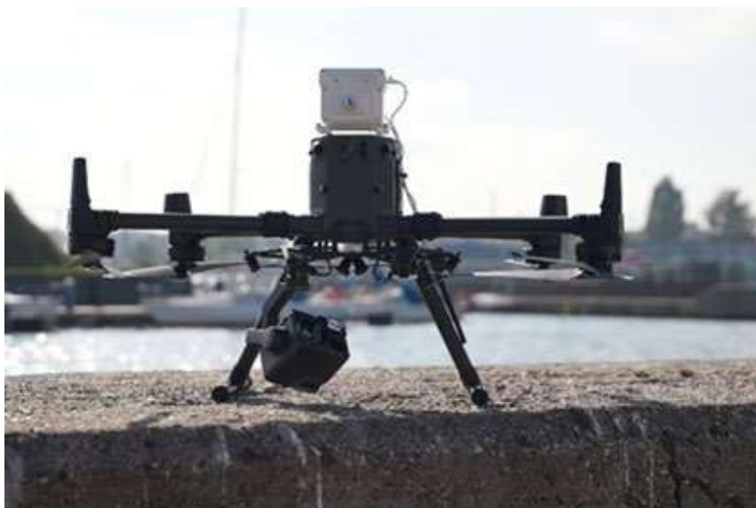
Rys. 3. Dron DJI Matrice 300 RTK z zainstalowanym czujnikiem zanieczyszczeń powietrza Sniffer 4D oraz z kamerą termowizyjną
