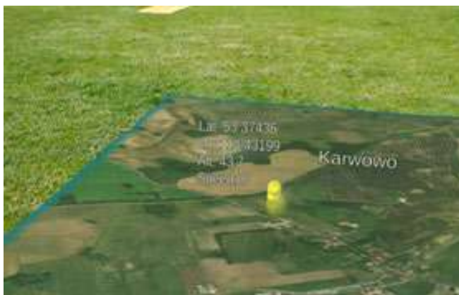
Rys. 6. Widok aplikacji z poziomu użytkownika korzystającego z urządzenia Microsoft HoloLens. Widoczna jest pozycja drona na trójwymiarowej mapie oraz punkty pomiaru jakości powietrza. Widok z testów środowiskowych (po lewej) oraz z terenu portu Kołobrzeg (po prawej)
