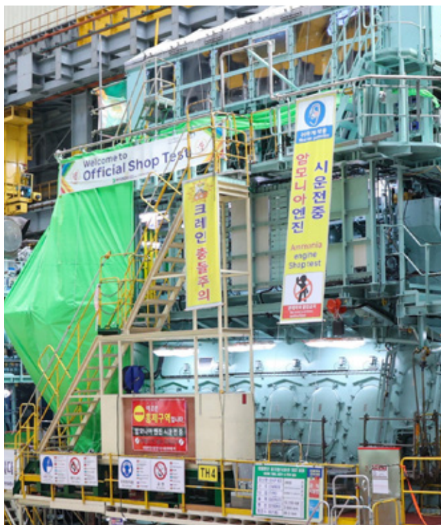
Silnik Everlence B&W 6G60ME-LGIA HPSCR w Engine & Machinery firmy Hyundai Heavy Industries podczas testów homologacyjnych w fabryce (źródło: [9])
