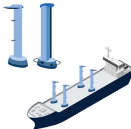
Ryc. 3. Przykład konstrukcji statku ze skrzydłem ssącym
